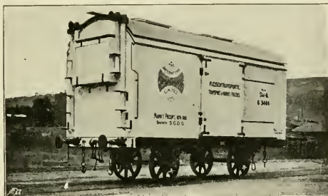
Abb. 358. Fleischtransport-Wagen. [System Mann.] [1885.]
